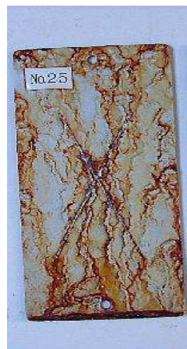
写真 2：従来工法(錆面シーラー+重防食塗料)
